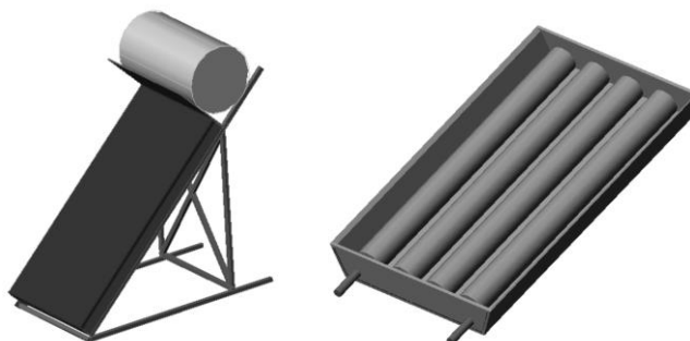
Obr. 2 Kompaktní funkční jednotka samotížné soustavy v Palermu (vlevo) a Princip integrovaného solárního kolektoru v Římě (vpravo), zdroje [1,4,15]
